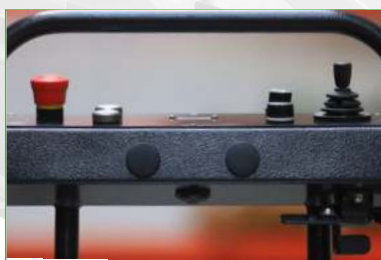
Sistema a doppia trazione comandato tramite joystick
